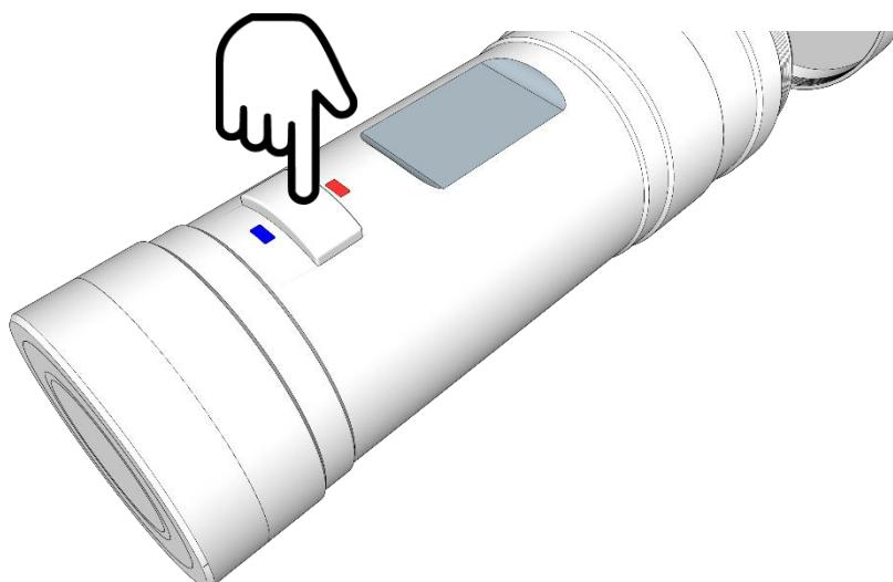
При использовании внешнего источника питания, регистратор автоматически включится и начнет видеосъемку.
