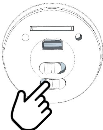
Переключатель **5** выключает / включает функцию циклической записи.
