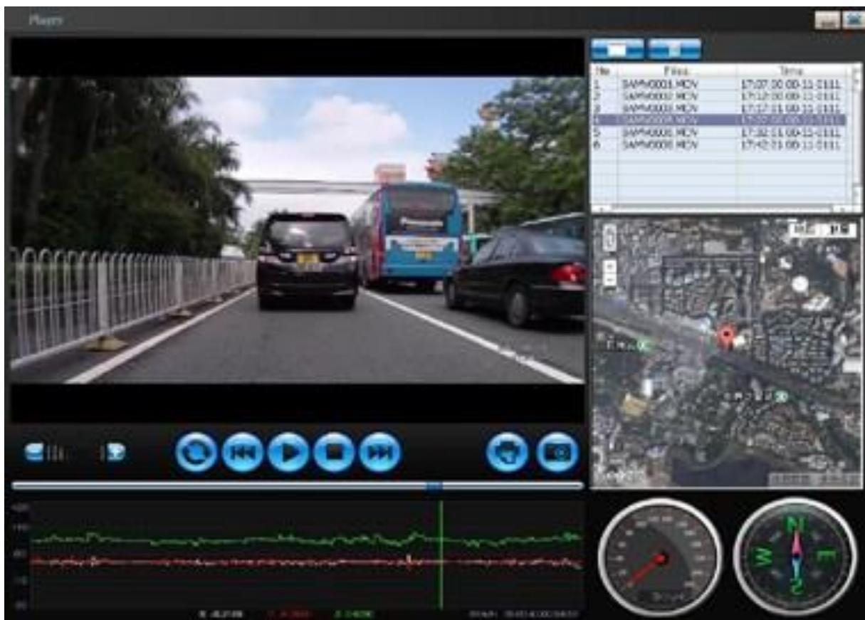
Для регистратора AdvoCam-FD Black-III (GPS+ГЛОНАСС) просмотр видео возможен одновременно с просмотром положения автомобиля на Google-карте. Кроме того, проигрыватель позволяет удалять ненужные записи, делать скриншоты и распечатки изображений.
