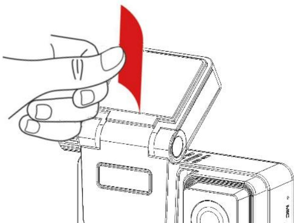
2. Присоедините блок регистратора к кронштейну, снимите защитную пленку с клеевой площадки кронштейна и прикрепите регистратор к лобовому стеклу за зеркалом заднего вида, в одной из зон как показано выше.
